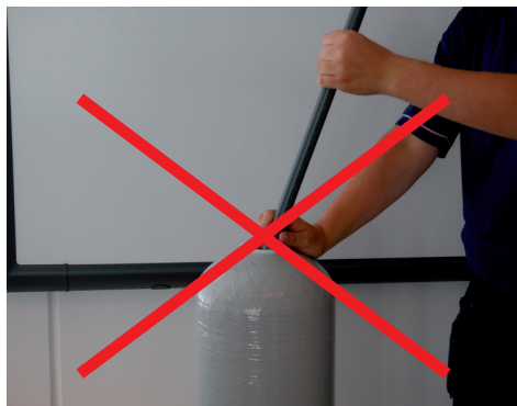
- Figur 6 - Udtrækning af stigerør
